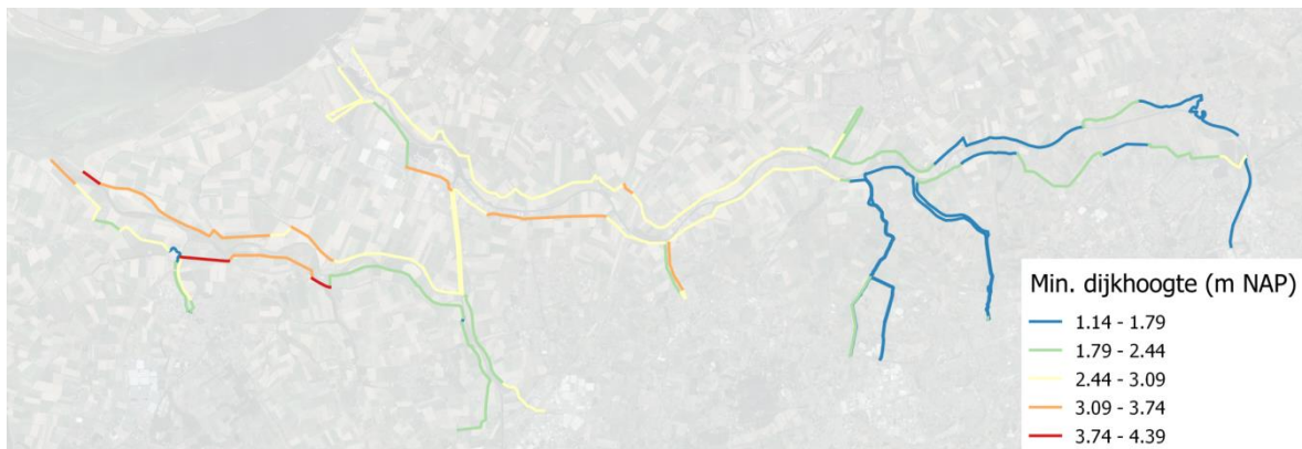
Figuur 3.3 Minimale dijkhoogte per dijkvak (bron: Waterschap Brabantse Delta).
