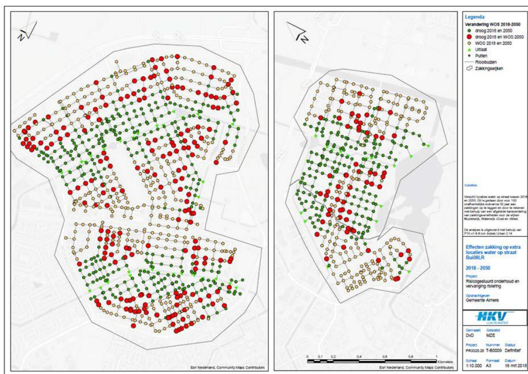
Figuur 4.31. Verschil in water op straat locaties bij een gekozen bui in 2050 ten opzichte van 2018 als gevolg van 32 jaar zetting. De linker afbeelding toont Muziekwijk en de rechter afbeelding Waterwijk.
